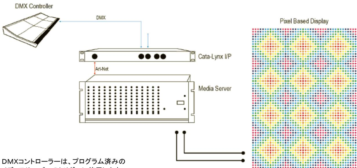
DMXコントローラーは、プログラム済みのメディアサーバーのトリガーに使用します。Cata-Lynx I/Pで、DMXをArt-Netに変換します。
